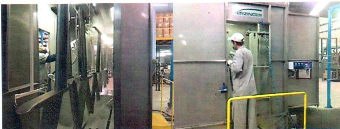
Figura 08. Cabine de pintura a Pó
