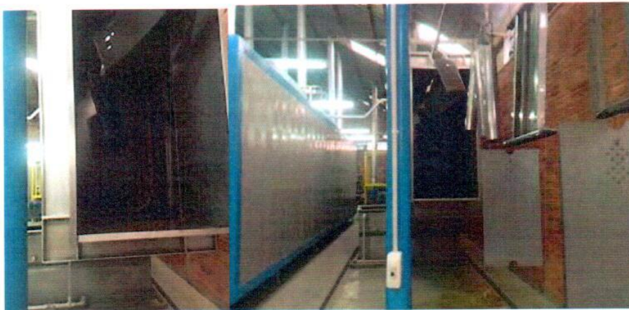
Figura 05. Sistema de lavagem e enxágue das peças
